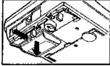
Helyezze be a három R6 (AA, UM-3) típusú elemet, gondosan ügyelve a megfelelő polarításra.
